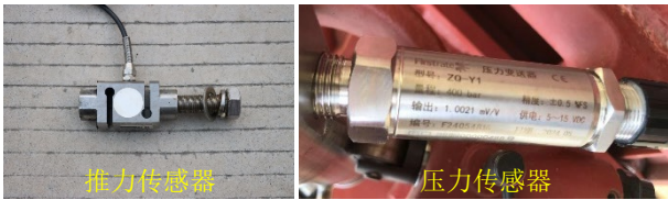
图5 推力传感器与压力传感器
